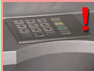
Klawiatura z założoną nakładką
